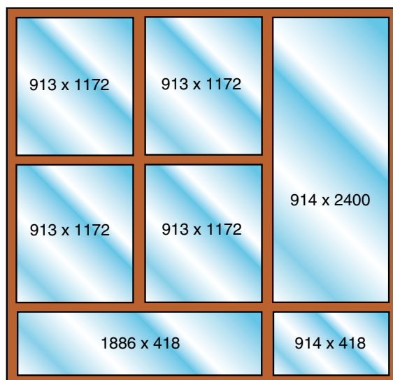
Voorbeeld realisatie (in mm) De lengte van de wand is onbegrensd
